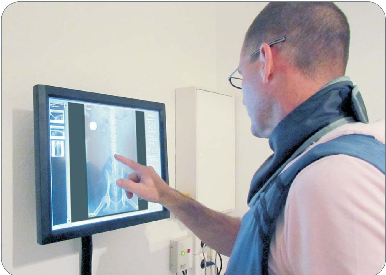
Die **dicomPACS® DX-R** Akquisitionsoftware wird per Touchscreen bedient. Anschließend werden die erstellten Bilder mit dem **dicomPACS® vet** Bildmanagementsystem befundet und archiviert.
