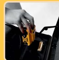
**Austausch** der Akkus während des **laufenden Betriebes**, kein Herunterfahren des Systems notwendig
