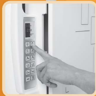
Bucky mit fest eingebautem Detektor besitzt sämtliche Bedienelemente wie das Display, inkl. SID, Höhe und ROT-Anzeige
