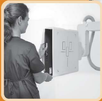
Herausnehmbares Raster inkl. Aufbewahrungsschacht bei Nichtgebrauch
