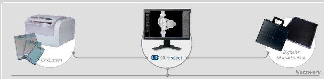
Die Software erlaubt standardmäßig die gleichzeitige Steuerung eines CR-Systems und eines oder mehrerer Röntgendetektoren
